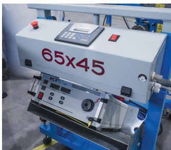
Painel de controlo intuitivo e gerador de electricidade estática
