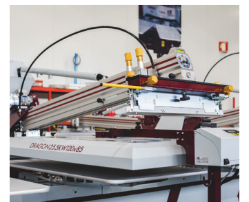
Capacidade de posicionamento dos Flashes por baixo de cabeças de impressão (quando em posição de limpeza)
